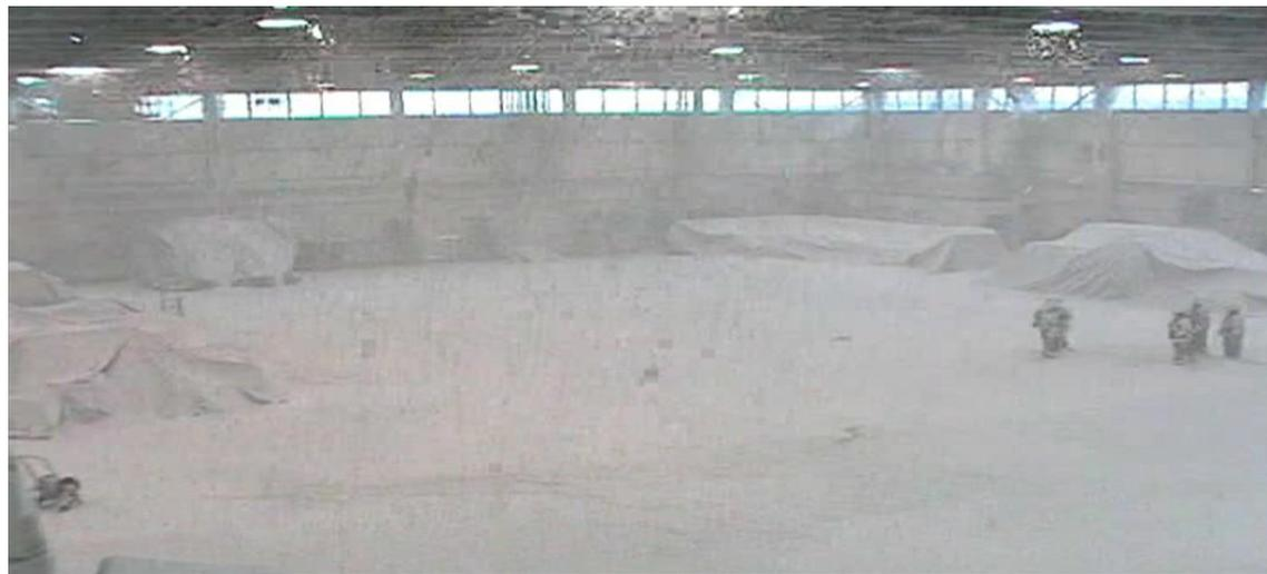
Работа ротационных оросителей, предназначенных для равномерного распределения компрессионной пены по площади
