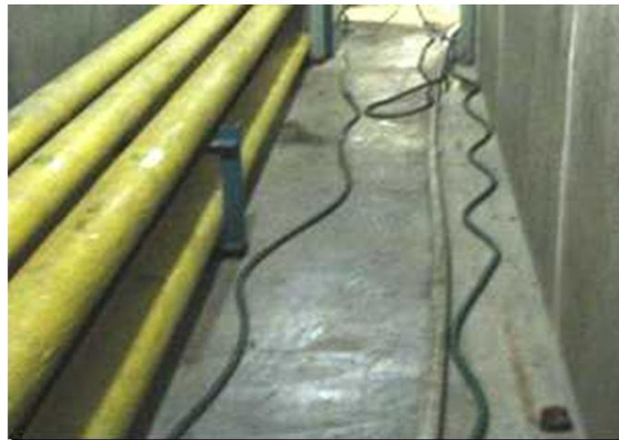
Вид помещения через 16 часов после тестового тушения (уборка пены не производилась, остаток пены минимален)
