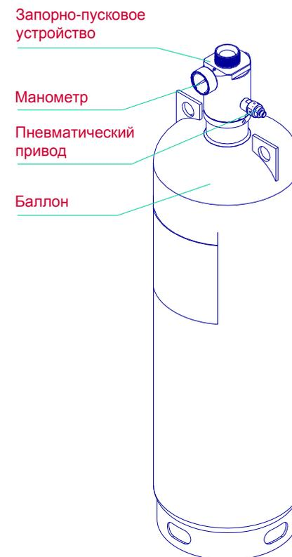
Модуль газового пожаротушения
